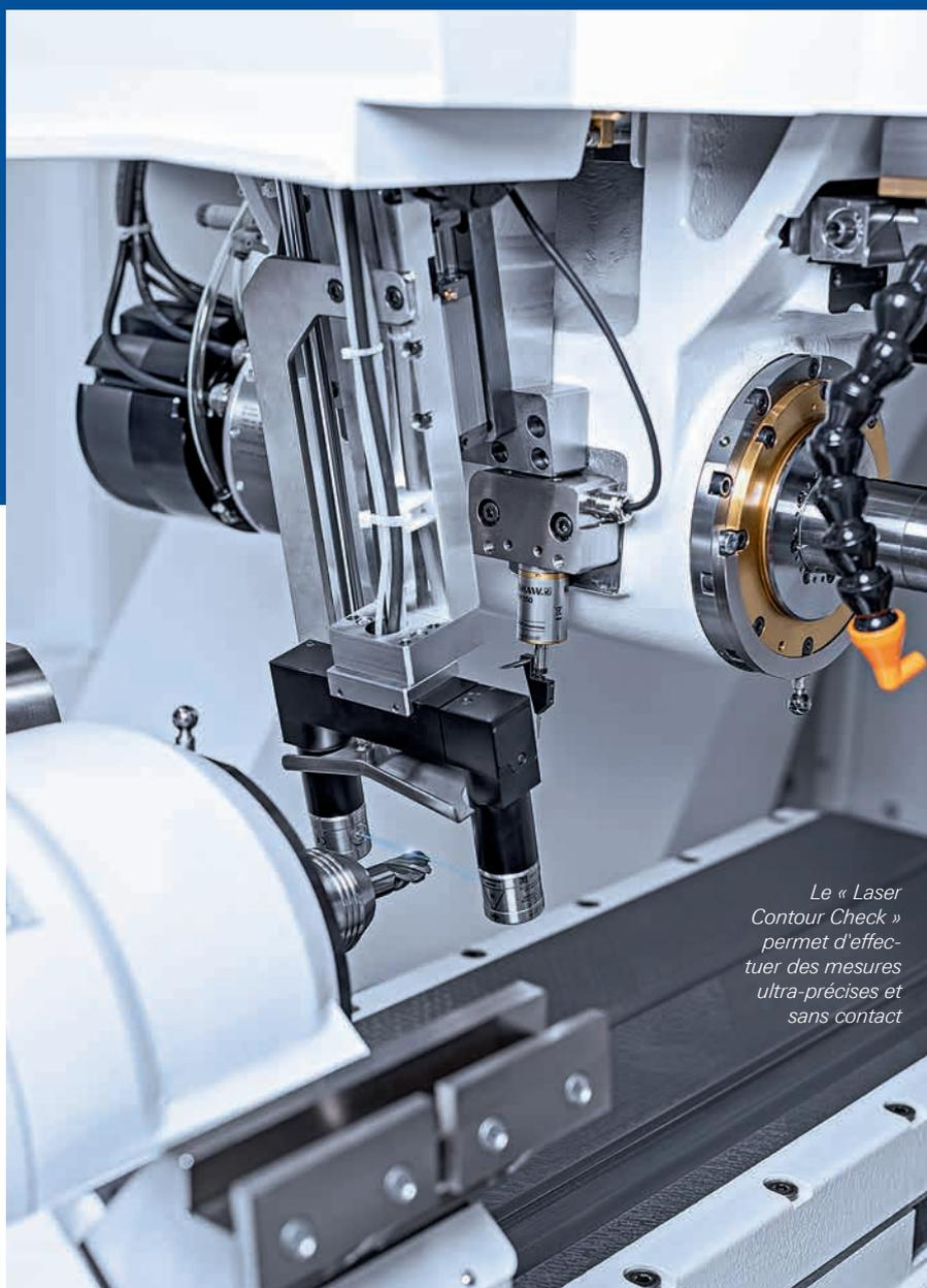
*Le « Laser Contour Check » permet d'effectuer des mesures ultra-précises et sans contact*
