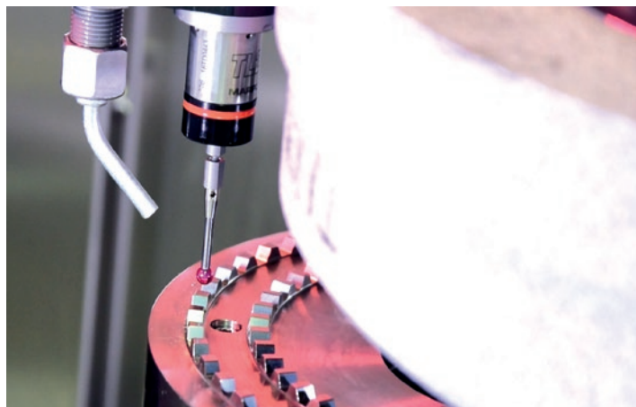
La touche de mesure détermine les paramètres qualité définis pendant la rectification.
