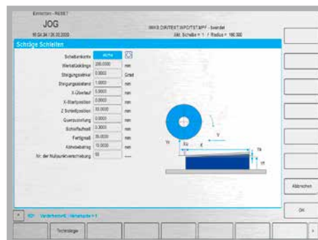
Maschera di programmazione per la rettifica di una superficie inclinata
