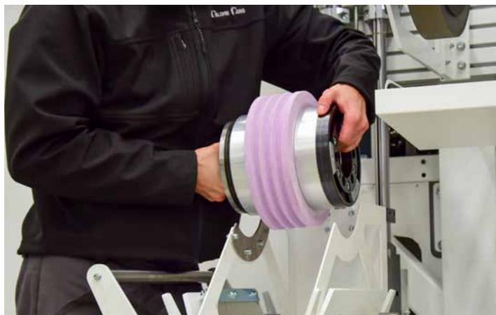
L'aide au placement permet un réglage **facile et sûr** des meules pendant la production. Cela réduit encore les temps de réglage.
